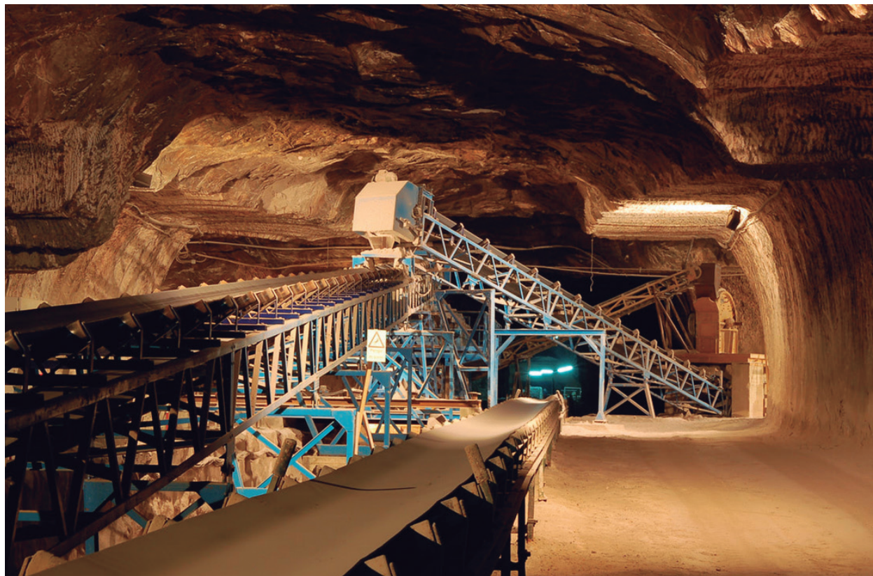
Depois de ser triturado, o sal é transportado pelo tapete rolante até ao poço 2
